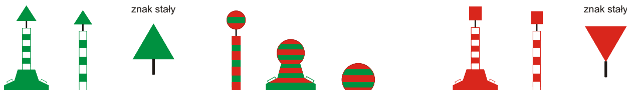
Miejsce niebezpieczne przy lewym brzegu.
