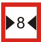
Ograniczona szerokość przejścia
