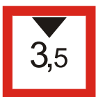
Ograniczona wysokość prześwitu nad lustrem wody
